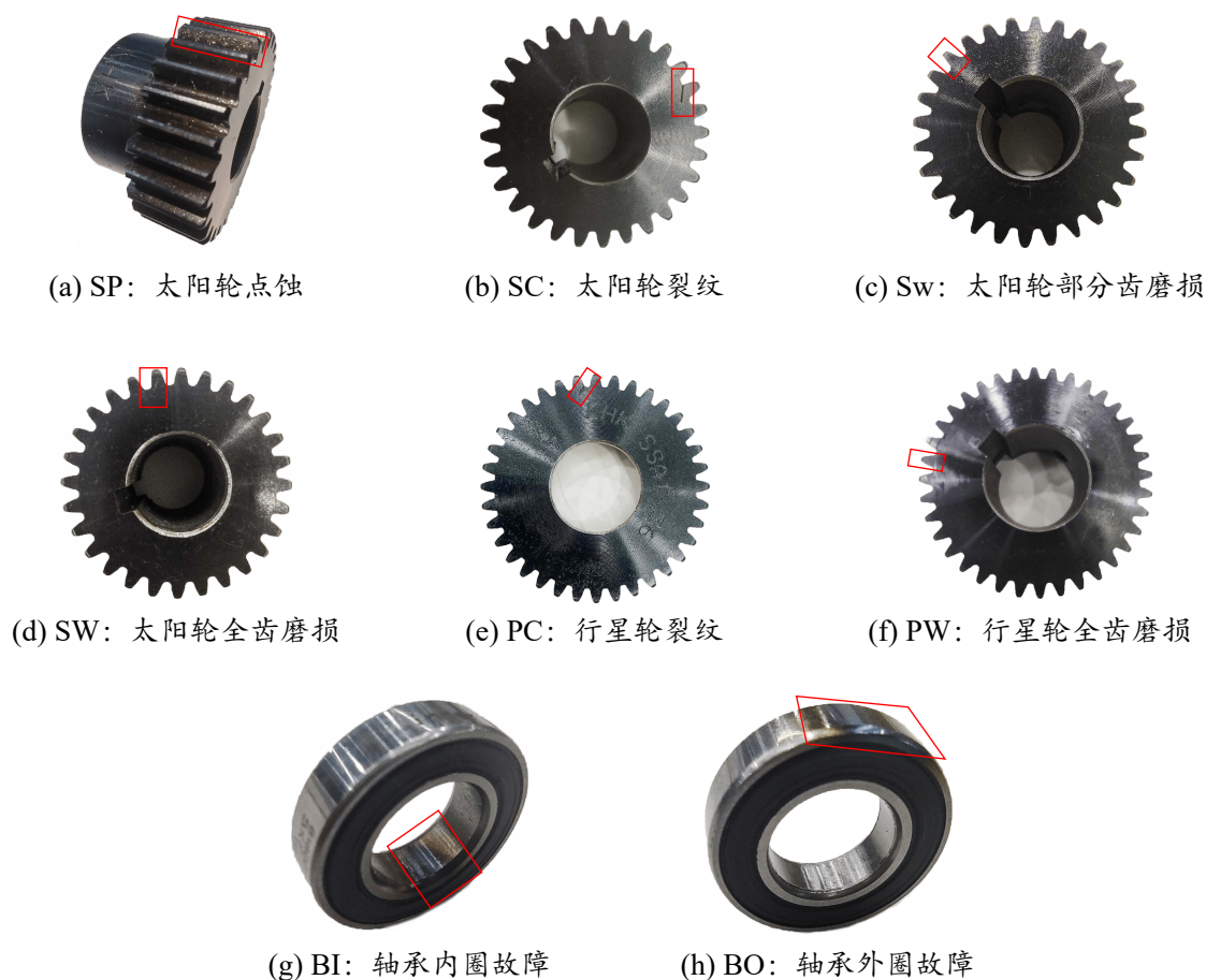
图 3-7 复合齿轮箱数据集所考虑的故障部件
